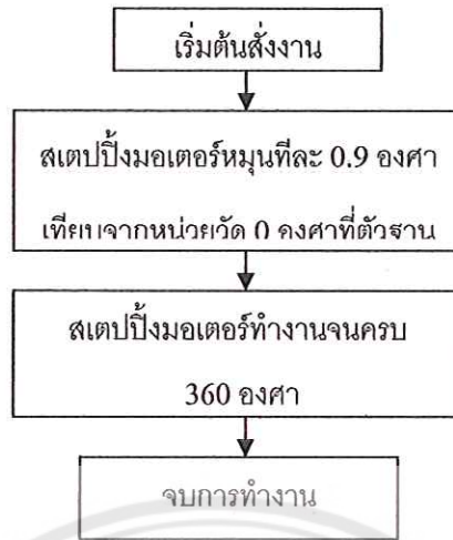
รูปที่ 3.10 แผนภาพแสดงการทำงานของสเตปป์มอเตอร์
