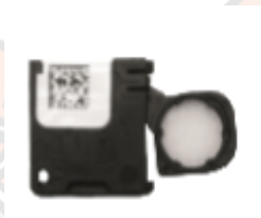
ภาพ 7 ลักษณะอุปกรณ์วัดปริมาณรังสีไอเอสแอล ชนิดนาโนดอท
