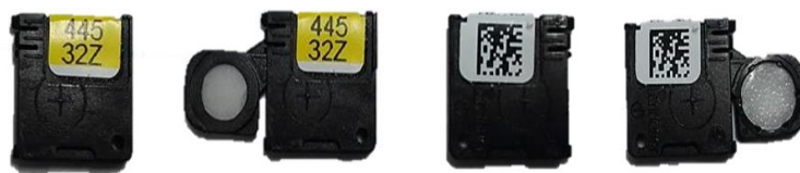
ภาพ 1 ส่วนประกอบของอุปกรณ์วัดรังสีไอเอสแอล ชนิดนาโนดอท
