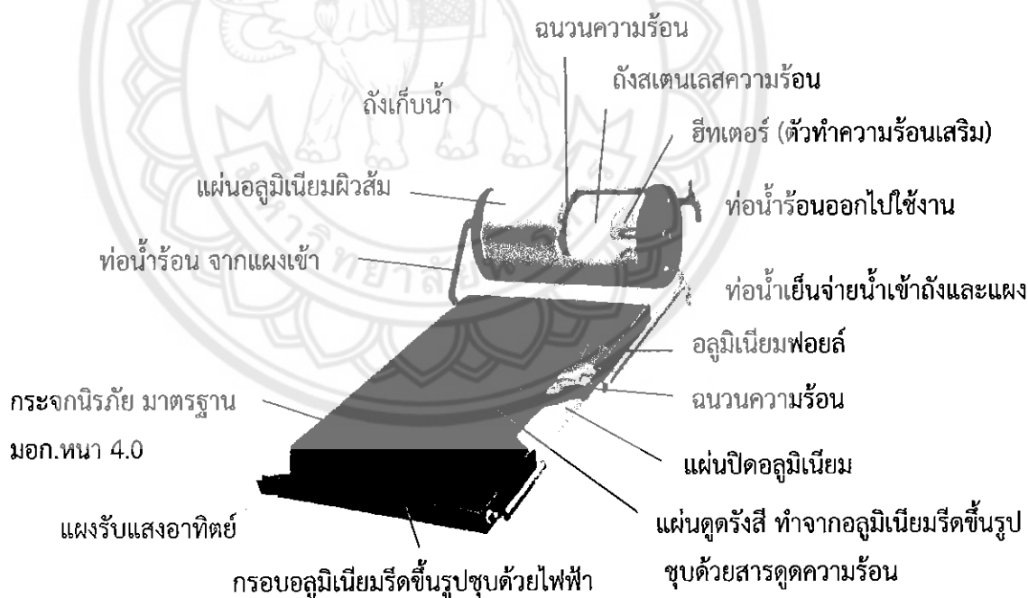
รูปที่ 2.4 ส่วนประกอบตัวรับรังสีแบบแผ่นเรียบ [4]
