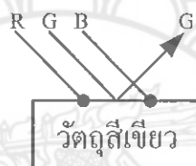
รูปที่ 2.4 การตกกระทบและสะท้อนของแสงจากวัตถุ
