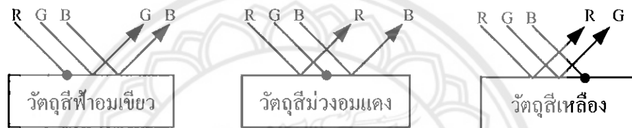
รูปที่ 2.6 การสะท้อนและดูดกลืนของแสงสีขาวเมื่อตกกระทบวัตถุที่มีสีทุติยภูมิ [1]
