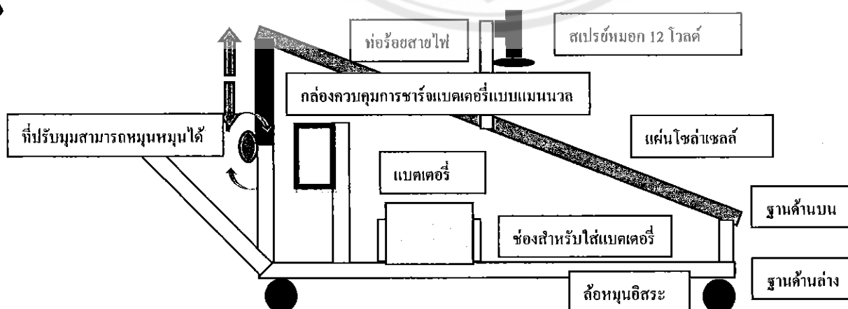
รูปที่ 3.39 ภาพรวมการติดตั้งสเปรย์หมอก 12 โวลต์
