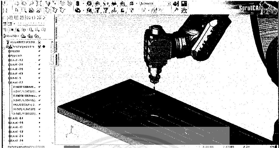
รูปที่ 4.13 ตั้งค่า set base และ set tool ของหุ่นยนต์ เพื่อเลือกขนาดของหัวกัด และ เครื่องมือกัดชิ้นงาน และเลือกตำแหน่งของสวดลายที่จะให้หุ่นยนต์ทำงานตามออกแบบไว้ เพื่อ กำหนดความเร็วในการเดินเครื่องจักร
