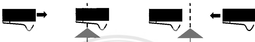
(ก) กรณีเคลื่อนที่ไปหน้า (ข) ถ้ามีกรณีเคลื่อนที่ย้อน รูปที่ 3.22 ตำแหน่งหลังหยุดของสวิตช์จำกัดระยะใน โครงงานปีการศึกษา 2558
