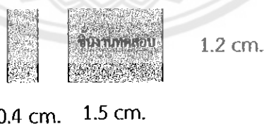
รูปที่ 3.11 ขนาดชิ้นงานทดสอบการดูดซึมน้ำ
