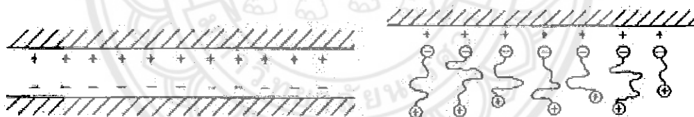
รูปที่ 2.10 แรงดึงดูดประจุหรือไฟฟ้าสถิต (Electrostatic Attraction) ที่มา: อธิธิพล (2544)
