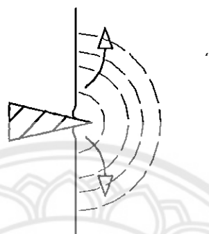
รูปที่ 2.6 แสดงการตัดแบบ Plastic cut (ที่มา : Mechanic of cutting plant material , Sverker Persson)
