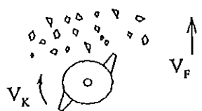
b) การเคลื่อนที่ของไถมีดแบบ Rotary หมุนเคลื่อนที่เข้าหาวัสดุตัด
