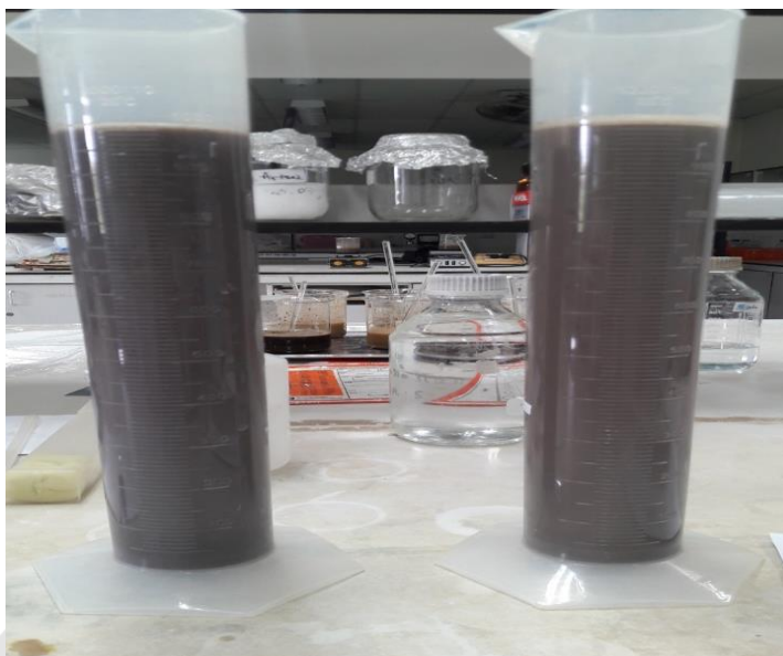
ภาพ 59 การวิเคราะห์เนื้อดินโดย Hydrometer method
