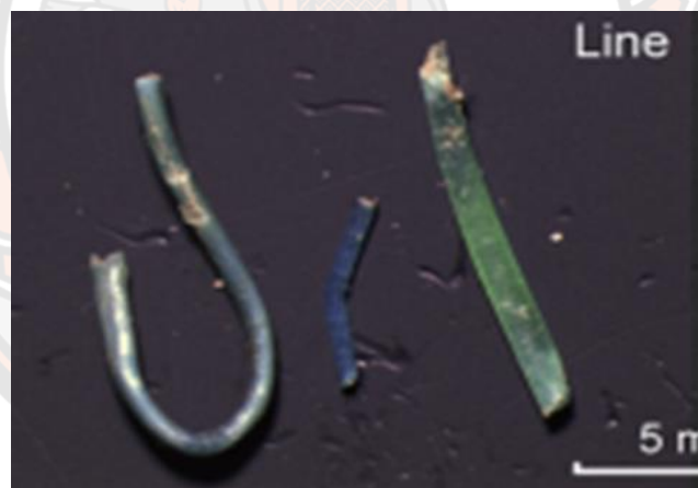
ภาพ 3 ตัวอย่างไมโครพลาสติกในรูปแบบเส้นหรือเส้นใย
