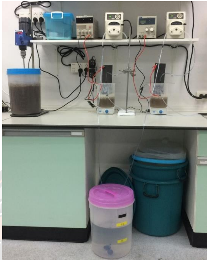
ภาพ 18 ภาพถ่ายถึงปฏิกรณ์แบบชีวภาพร่วมกับไฟฟ้าเคมีในห้องปฏิบัติการ
