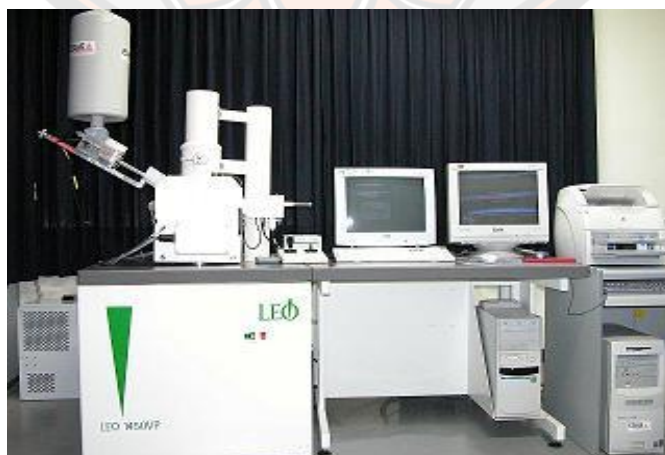
ภาพ ข-11 กล้องจุลทรรศน์อิเล็กตรอนแบบส่องกราด รุ่น Leo-1455VP ของบริษัท ZEISS
