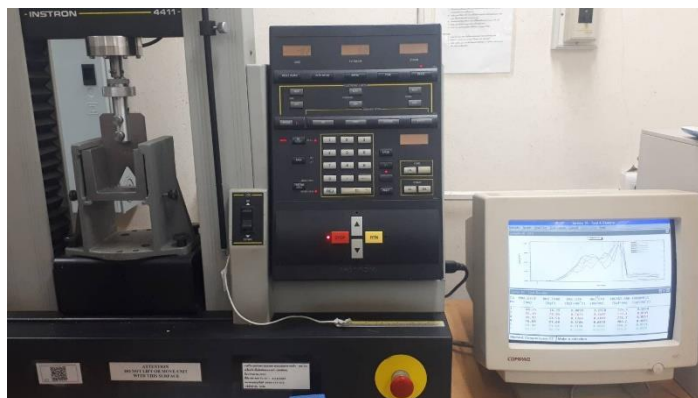
ภาพ ข-9 เครื่องวัดแรงดึง รุ่น 4411 ยี่ห้อ Instron
