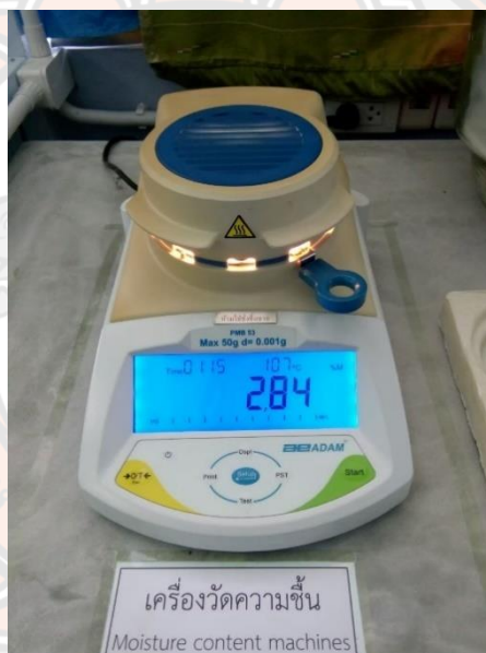
ภาพ ข-7 เครื่องวัดความชื้นแบบดิจิตอล รุ่น PMB 202
