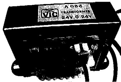
รูปที่ 3.2 หม้อแปลงไฟฟ้า
