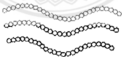
รูปที่ 2.9 แสดง โครงสร้างของพอลิพอฟิลีนแบบเส้นตรง[2]
