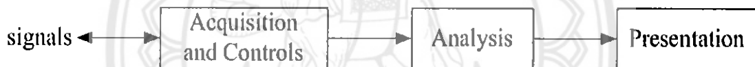
รูปที่ 2.4 แผนภาพแบบบล็อกของเครื่องมือวัดที่สร้างจากแลปวิว[1]
