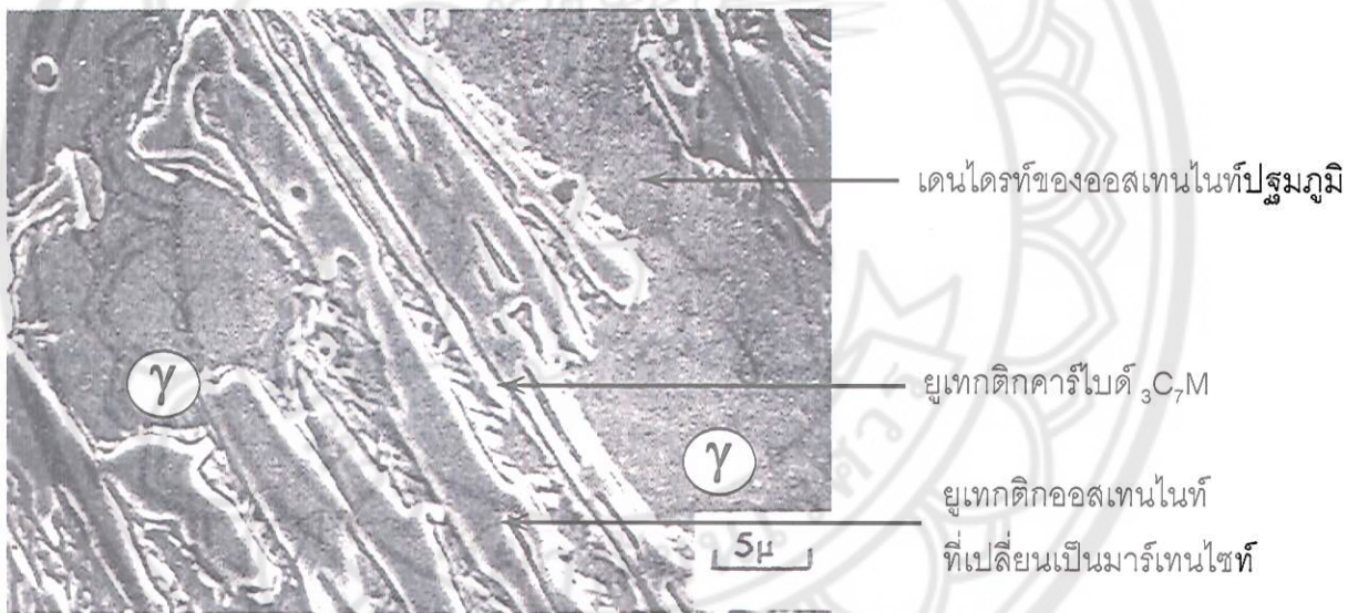
รูปที่ 2.3 โครงสร้างจุลภาคในสภาพหล่อของเหล็กหล่อโครเมียมสูง 30wt%Cr-2.4wt%C ที่ประกอบด้วยเดนไดรต์ปฐมภูมิ ยูเทคติกคาร์ไบด์ 3C_7M และยูเทคติกอสเทนไนท์ที่เปลี่ยนเป็นมาร์เทนไซต์
