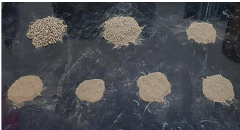
ภาพ 23 ตัวอย่างฝุ่นบนถนนจากการก่อสร้าง
