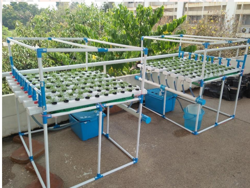
ภาพ 23 ระบบปลูกไฮโดรโปนิคส์แบบ NFT (ซ้าย) และ DFT (ขวา)
