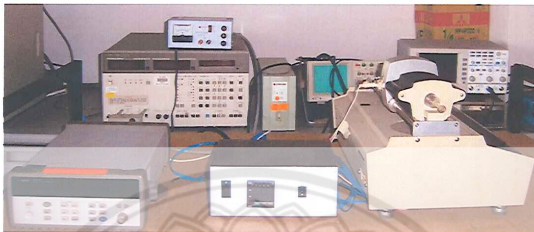
รูป 3.17 เครื่อง LCZ meter ต่อพ่วงกับเตาเผาและ Multimeter เพื่อวัดค่าความจุไฟฟ้าโดยการแปรค่าอุณหภูมิ
