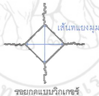
รูป 4.28 รอยกดแบบวิกเกอร์ที่เกิดขึ้นบนชิ้นงานเซรามิก
