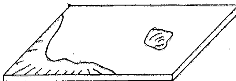
รูปที่ 2.18 การหดตัวของเคลือบ
