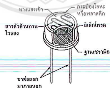
รูปที่ 2.12 โครงสร้าง LDR
