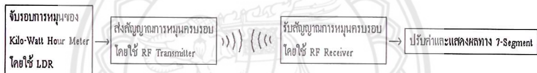
รูปที่ 2.1 ลักษณะการทำงานของเครื่องแสดงผลการใช้พลังงานไฟฟ้าระยะไกล
