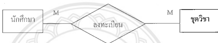
รูปที่ 2.10 ความสัมพันธ์แบบกลุ่มต่อกลุ่ม (Many-to-many Relationship)
