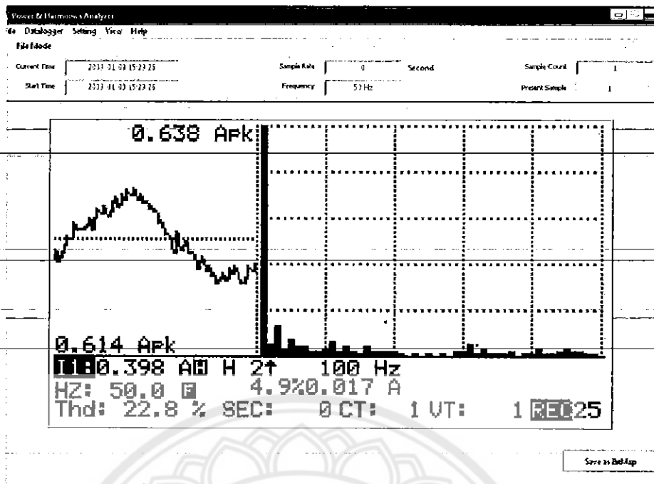
(ค). รูปคลื่นกระแสไฟฟ้าขาเข้าและการวิเคราะห์ฮาร์มอนิกส์ของบัลลาสต์แกนเหล็ก
