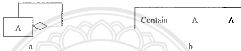
รูปที่ 4.7 a. UML ของ Composite Pattern, b. ภาษา RSF ที่แสดงความสัมพันธ์ของรูป a
