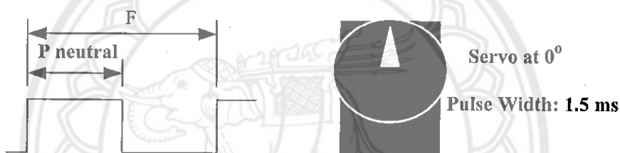
รูปที่ 2.21 สัญญาณความกว้างพัลส์ขนาด 1.5 มิลลิวินาที (ms) [4]
