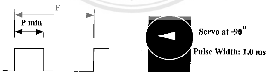
รูปที่ 2.22 สัญญาณความกว้างพัลส์ขนาด 1 มิลลิวินาที (ms) [4]
