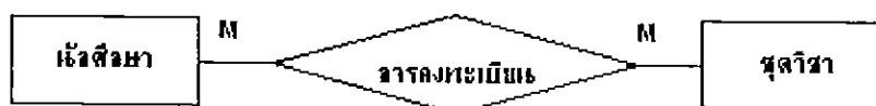
รูปที่ 2.20 ความสัมพันธ์แบบกลุ่มต่อกลุ่ม (Many-to-many Relationship)
