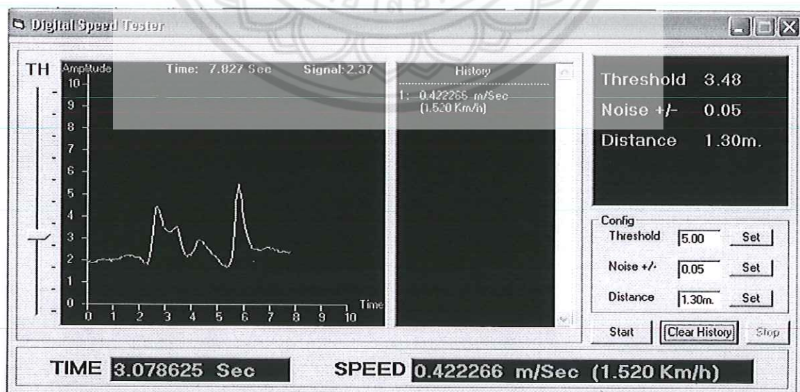
รูปที่ 4.6 แสดงผลการทดลองบนคอมพิวเตอร์ของตัวตรวจจับสนามแม่เหล็กโลก 1 ชุด เมื่อนำรถยนต์วิ่งผ่านที่ความเร็ว 1.520 km/hr
