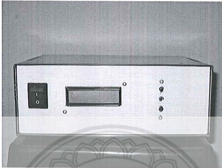
รูปเครื่องวัด วัตต์ วาร์ เพาเวอร์แฟคเตอร์ แบบดิจิทัลแบบเสร็จสมบูรณ์
