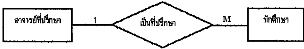
รูปที่ 2.19 ความสัมพันธ์แบบหนึ่งต่อกลุ่ม [2]
