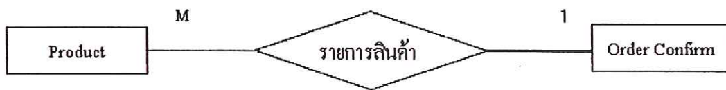
รูปที่ 4.7 ความสัมพันธ์ระหว่างตาราง Product และตาราง Orders Confirm
