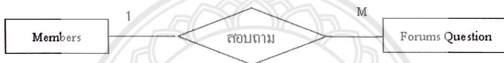
รูปที่ 4.8 ความสัมพันธ์ระหว่างตาราง Member และตาราง Forums Question
