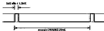
รูปที่ 3.2 แสดง ลักษณะของ Pulse สำหรับควบคุมให้มอเตอร์หมุนทางซ้ายนาฬิกา
