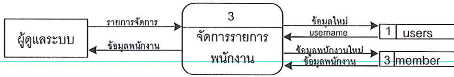
รูปที่ 3.6 แสดง Data Flow Diagram Level 0 ของการจัดการรายการพนักงาน
