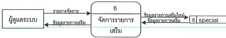
รูปที่ 3.12 แสดง Data Flow Diagram Level 0 ของการจัดการรายการเสริม
