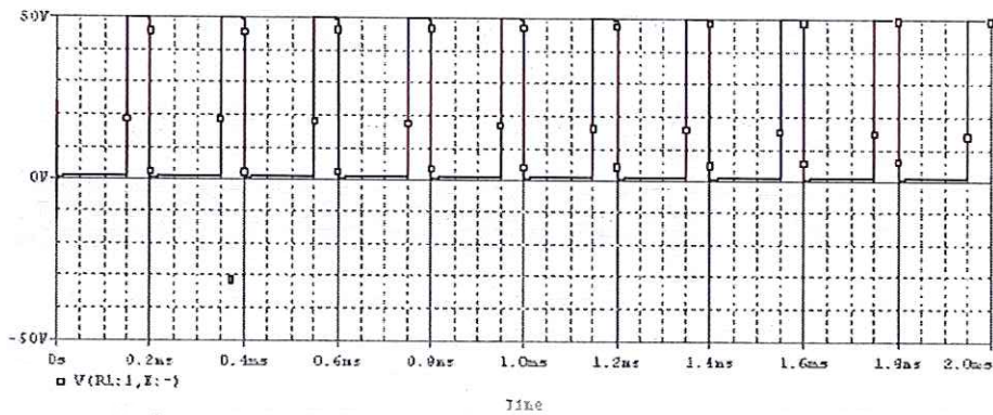
รูปที่ 4.6 สัญญาณแรงดันเอาต์พุตที่ได้จากการวิเคราะห์วงจรรูปที่ 4.5
