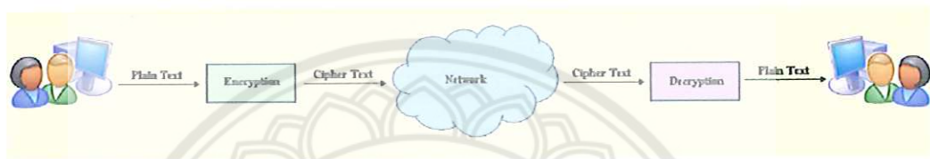
รูปที่ 2.1 การเข้ารหัสข้อมูล (Encryption)
